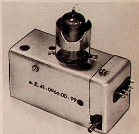
Bild 1. Telefunken-UKW-Eingangs- und Mischteil mit der Doppeltriode ECC 85
