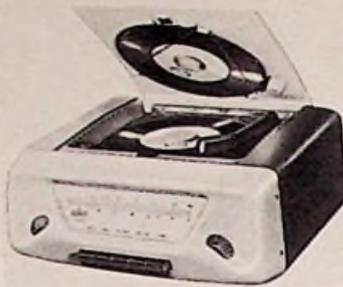
Ein sparsamer Permanentfeldmotor (Leistungsaufnahme 4 V/20 mA = 0,08 Watt) treibt über Reibrad den Plattenteller mit Schwungmasse an. Diese, sowie eine elektrische Drehzahlregelung, sichern Konstanz der Tourenzahl. Für die Stromversorgung werden neben dem Wechselstromnetzteil 117..220 V benötigt: 90-Volt-Anodenbatterie, drei Babyzellen für den Motor und zwei Monozellen für die Heizung.
